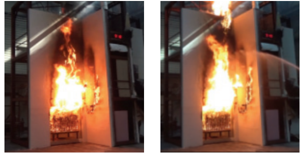
(c) Fire Flame over Apparatus (9:18) (d) Extinguishment (9:48)
